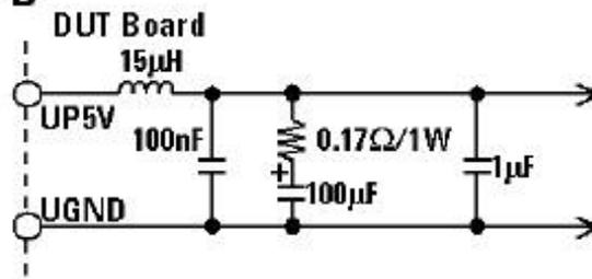
下記はフィルタタイプ A を使ってユーザーリレーを制御するためのサンプル回路です。
